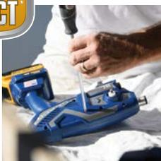
1. Retire la cubierta con un destornillador.
