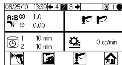
FIG. 16. Pulverización de mezcla en ejecución (pantalla 2)
